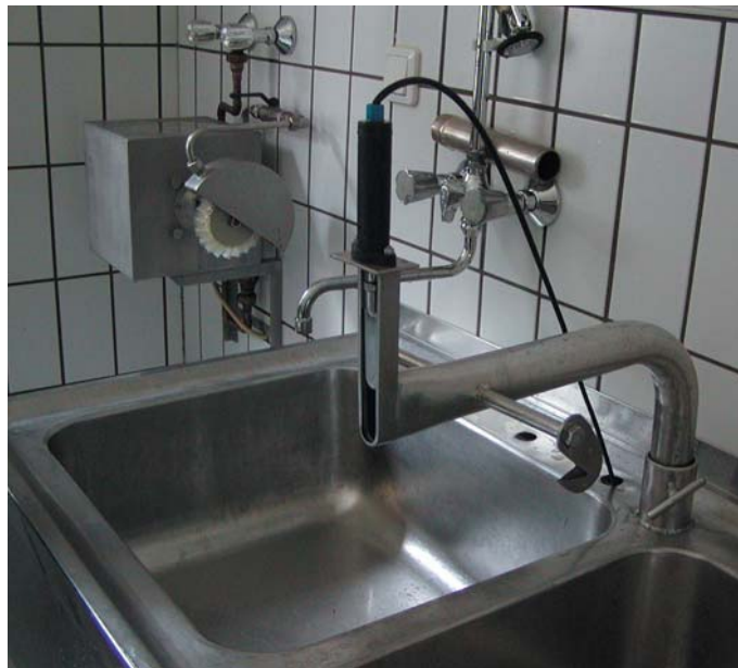
Иллюстрация 2. Простое, но полностью удовлетворительное место для чистки рыбы (вверху слева). Нож для разрезания брюшка и трубка для отсасывания внутренностей вместе с дисковой щёткой для промывки рыбы изнутри (вверху справа и внизу слева)
